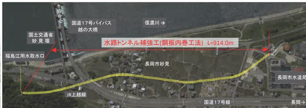
刈谷田川土地改良区と福島江土地改良区は『福島江刈谷田川大堰土地改良区連合』を組織し福島江用水路を管理していますが、最上流の本水路トンネルは50年以上が経過しており、全線にわたり亀裂が生じているほか、トンネルのアーチ部と側壁部の施工継目から漏水が見られ、トンネル構造として一体的に機能していない状況でした。また、築造後の社会的変化により、トンネル地上部には住宅や国道、JRなどの公共交通機関が走りトンネルの陥没による甚大な被害が予想されることから、施設の更新が求められていました。
